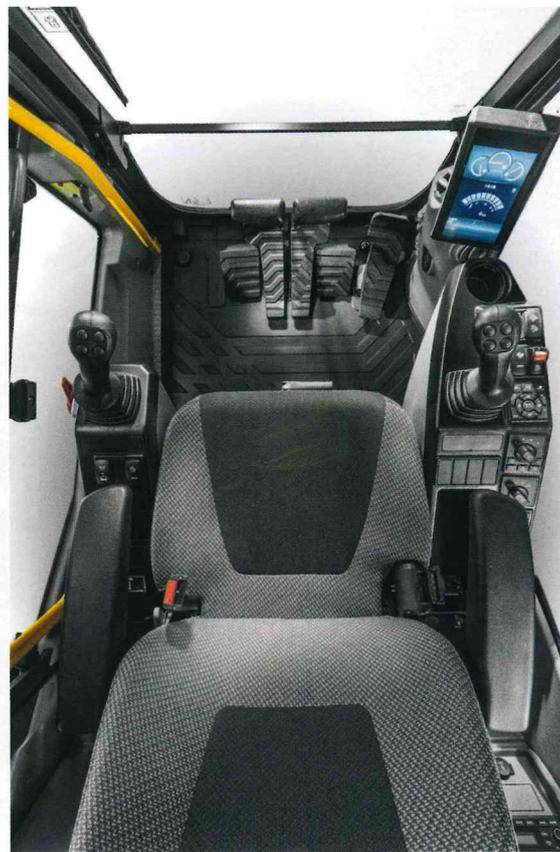
L'escavatore Volvo, che presso Conti viene utilizzato con il radiocomando, in ogni caso presenta una cabina con interfacce ergonomiche e personalizzabili
