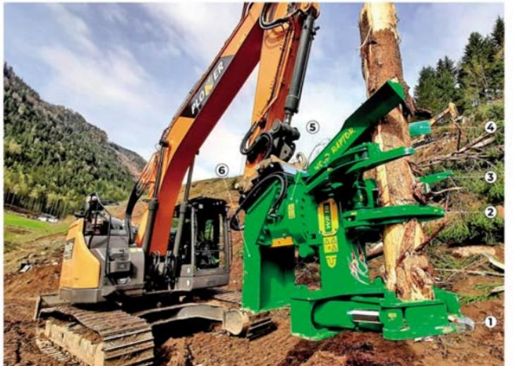
**1:** Système innovant de coupe à double lame. Les lames sont fabriquées dans un matériau résistant à l'usure et réversible.
