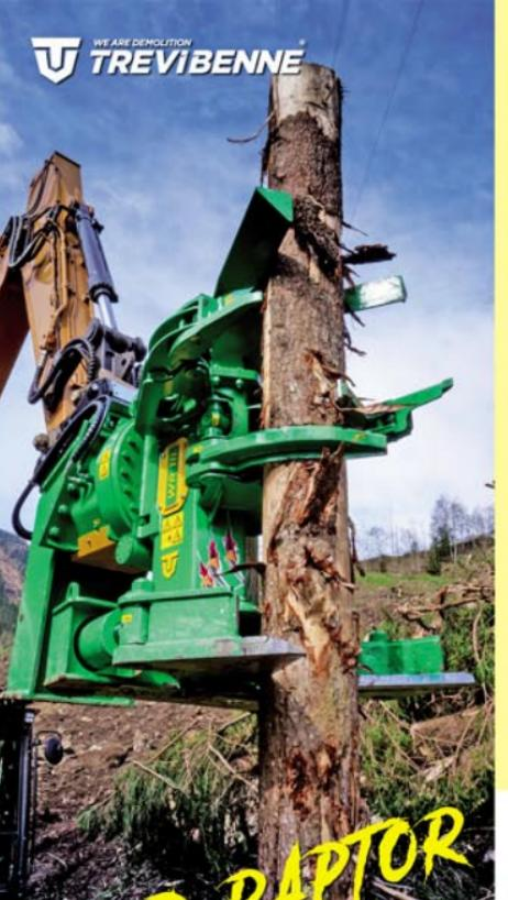
La nuovissima Pinza Abbattitrice **Serie WR** è un'attrezzatura prevalentemente indicata per il taglio e la raccolta di legname su larga scala in aree boschive, per l'abbattimento di alberi pericolanti, per la coltivazione e lavori di cura e manutenzione del paesaggio. Efficace per operare su forti pendenze, terreni scoscesi e di difficile accesso.
